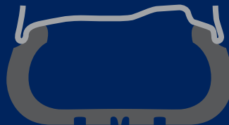
Конструкция шины MICHELIN ZP
