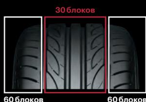
Увеличивают жесткость блоков протектора и делают отклик на управляющие воздействия более четким. Увеличивают площадь пятна контакта. Уменьшают шум, издаваемый шиной.
