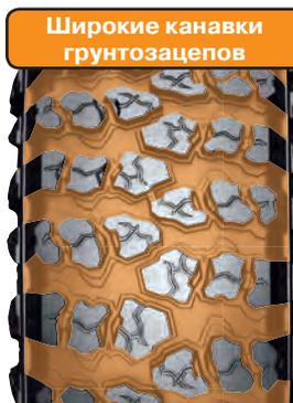
Широкие канавки грунтозацепов обеспечивают экстремальную проходимость на бездорожье.
