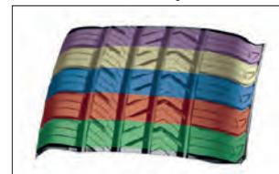
Снижение уровня шума шины достигается благодаря пятишаговой вариации блоков протектора G057.
