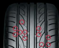
В отличие от обычных канавок, канавки уменьшенной глубины имеют дополнительное влияние на характеристики шины. Увеличивают жесткость блоков протектора и делают отклик на управляющие воздействия более четким.
